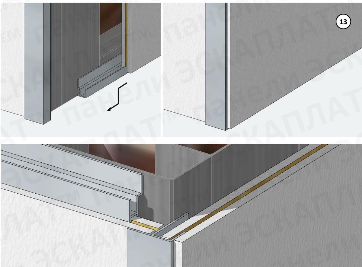
14. **Монтаж наружного угла. ВАРИАНТ 2.** Подрезается панель под уровень стойки каркаса на смежной стене. Монтируется панель на смежную стену, применяя L опорный и Н верхний горизонтальный профиль. Подрезанный торец должен быть перекрыт. С помощью герметика монтируется Г-образный внешний профиль в паз панели на смежной стене, перекрывая стык.
